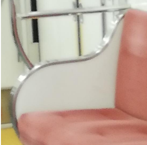
↑プラスチック製になった袖仕切り
